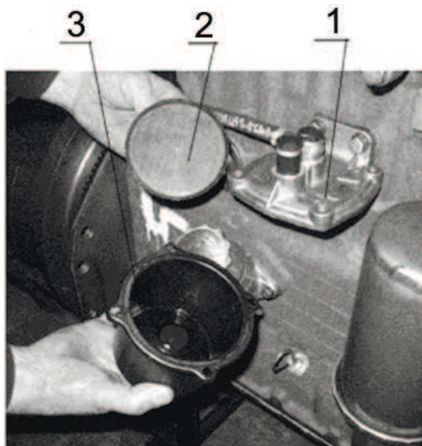
1 - корпус фильтра; 2 - отражатель с сеткой; 3 - стакан
